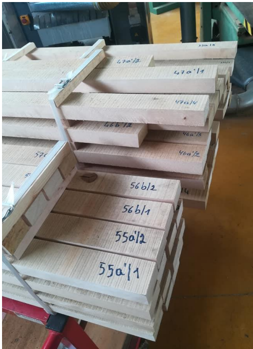
Figure 28 : Eprouvettes finales, triées et dimensionnées au LTB, et destinées aux essais d'usinage chez Kewlox.
