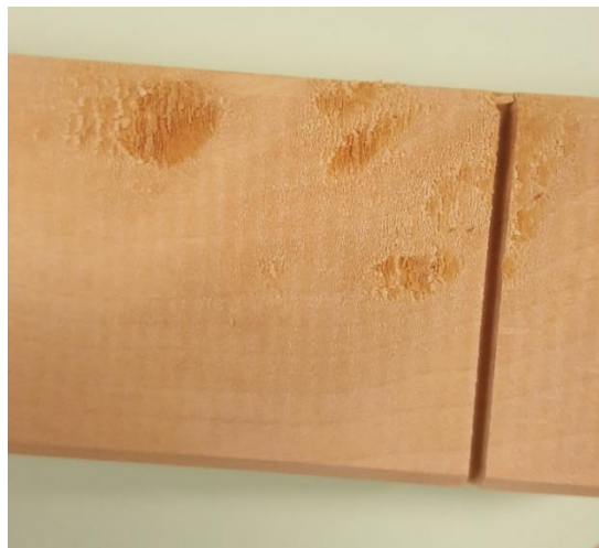
Figure 40 : Aspect de surface du bois dû au contrefil.
