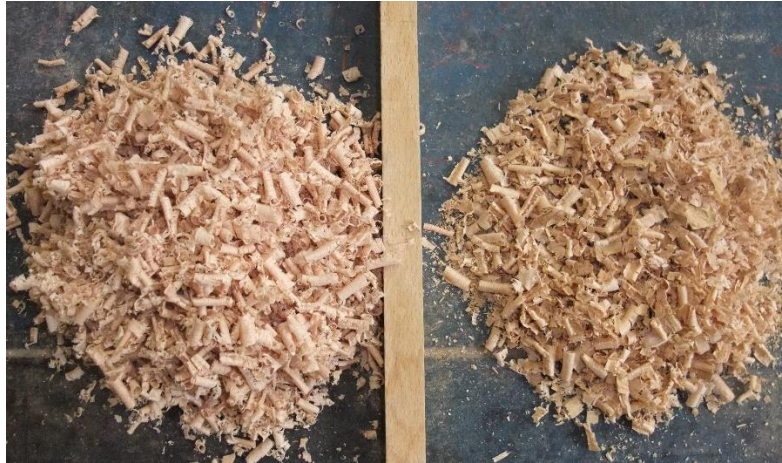
Figure 32 : copeaux issus du pré-rabotage. Hêtre à gauche et bouleau à droite.
