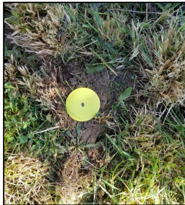
FIGURE 7 : Marqueur GPS utilisé pour géo-référencer les photos prises par le drone.
