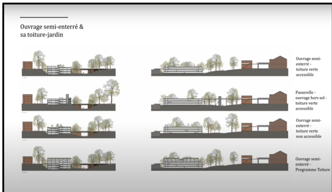
Figure II.1.27 : Parking semi-enterré et sa toiture-jardin (Source : Matexi)
