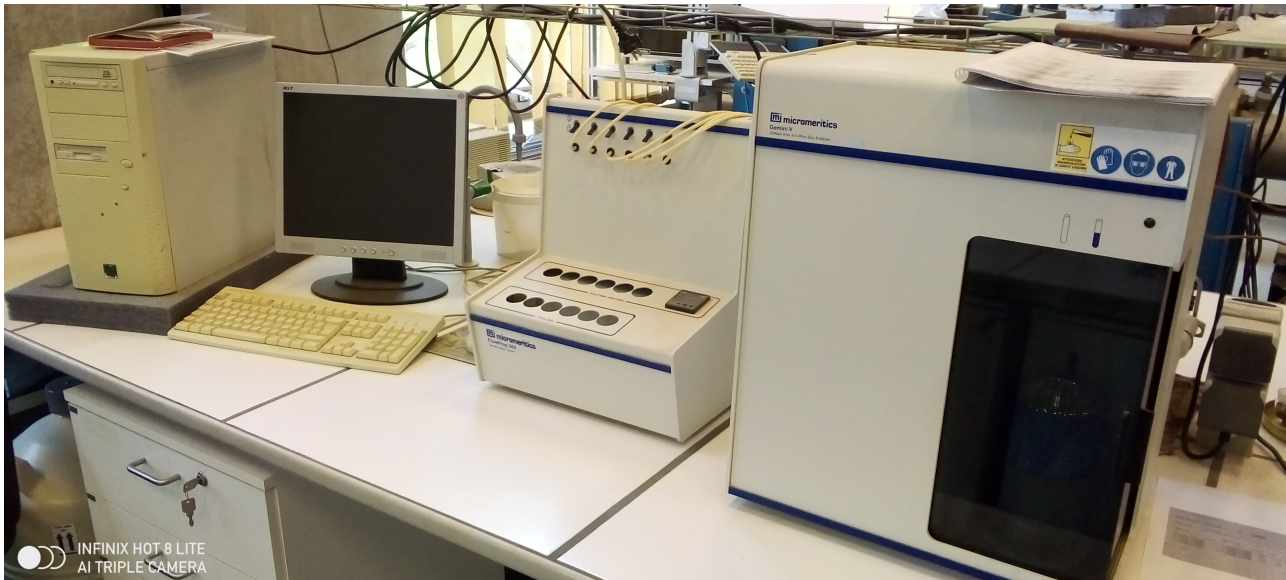
FIG. 55 Vue d'ensemble du dispositif d'analyse de détermination de surface spécifique
