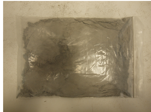
FIG. 41 Fines de fibres-ciment
