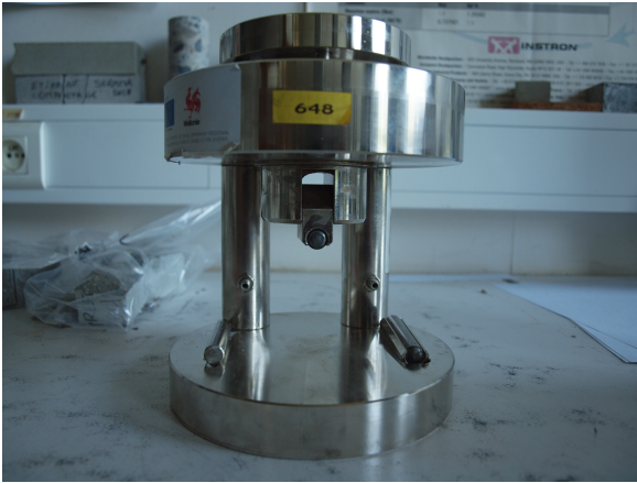
FIG. 63 Dispositif de flexion utilisé
