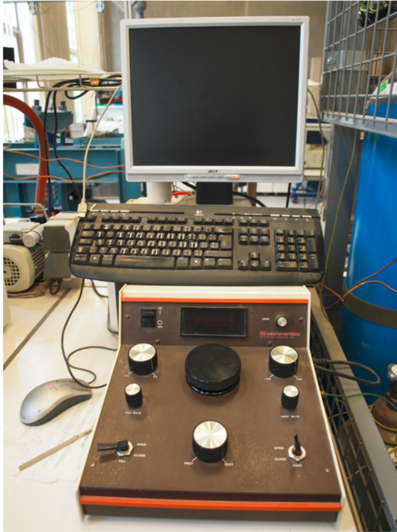
FIG. 52 Vue d'ensemble du dispositif du pycnomètre à gaz
