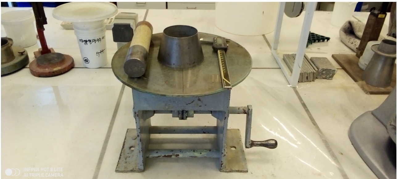
FIG. 59 Table à secousses, dame, pied à coulisse et moule tronconique
