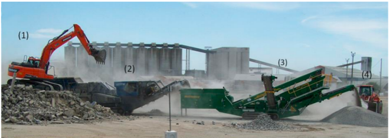
FIG. 5 : Différentes étapes de la production des Granulats Recyclés de Planète Recyclage : (1) Préparation par broyage des blocs de béton armé et déferrage à l'aide d'une pince de type BRH, (2) concassage, (3) criblage et (4) stockage (source : Recyment). [6]
