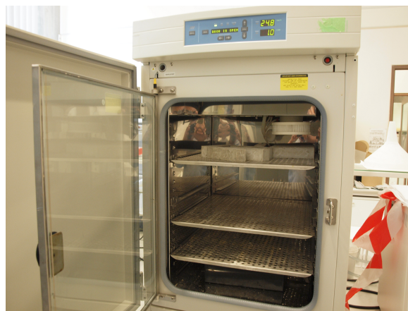
FIG. 50 Enceinte de carbonatation.
