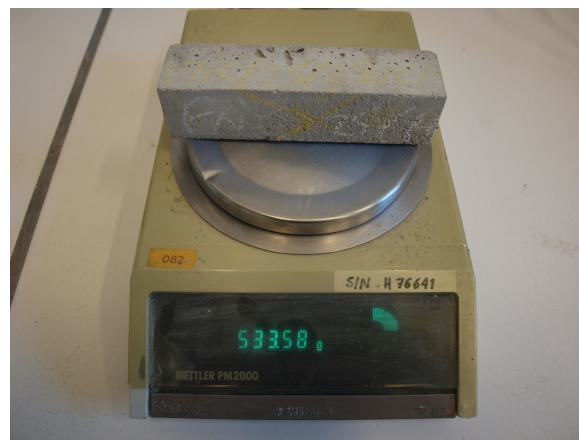
FIG. 70 Pésée à l'air de l'éprouvette sèche
