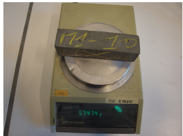
FIG. 67 Pésée à l'air de l'éprouvette humide
