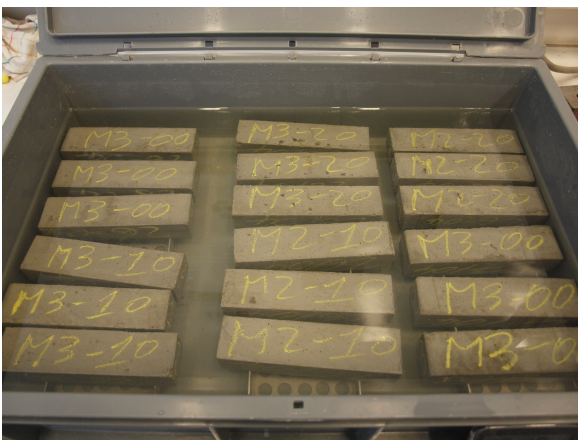
FIG. 66 Immersion des éprouvettes de mortier
