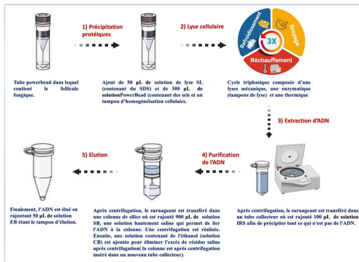
**Figure 60** : schéma simplifié de l'extraction d'ADN (kit Qiagen)
