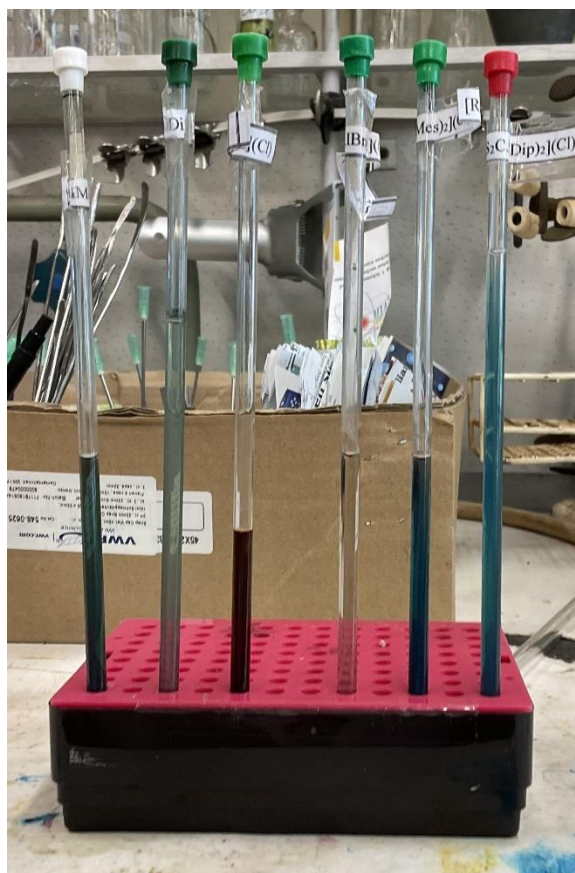
Figure S44 : Test de solubilité des catalyseurs Ru dans l'eau. De gauche à droite , on a les catalyseurs : 1 – 2 – 3 – 4 – 5 – 6. Seul 3 ([Ru(S 2 CNEt 2 )(S 2 C·ICy) 2 ]Cl) est soluble dans l'eau.
