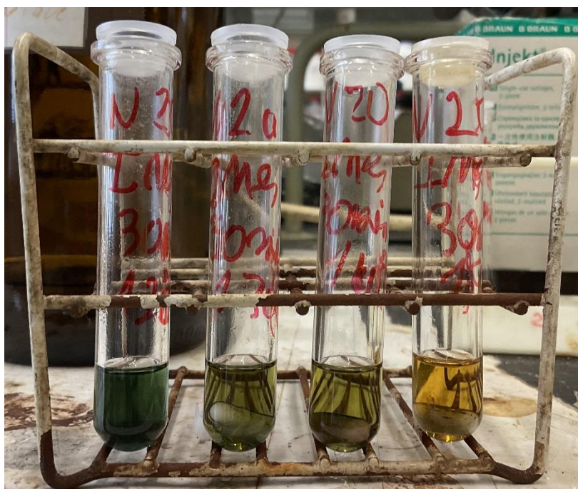
Figure S3 : Solutions avec le catalyseur [Ru(S_2CNEt_2)(S_2CIMes)_2]Cl ( 1 ) après différentes températures de chauffage durant 30 min. De gauche à droite : 120 °C – 130 °C – 140 °C – 150 °C.
