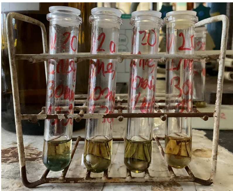
Figure S4 : Solutions avec le catalyseur [Ru(S_2CNEt_2)(S_2C \cdot IMes)_2]Cl ( 1 ) après différentes températures de chauffage durant 30 min. De gauche à droite : 120 °C – 130 °C – 140 °C – 150 °C après 24 heures.
