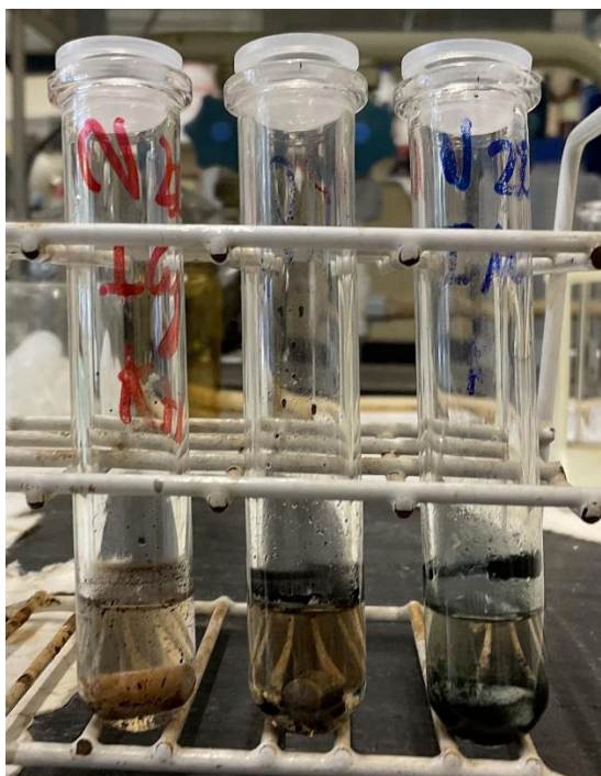
Figure S20 : Solutions de l'ATRA sans phosphines après chauffage. De droite à gauche , on a les catalyseurs : 1 – 2 – 3.
