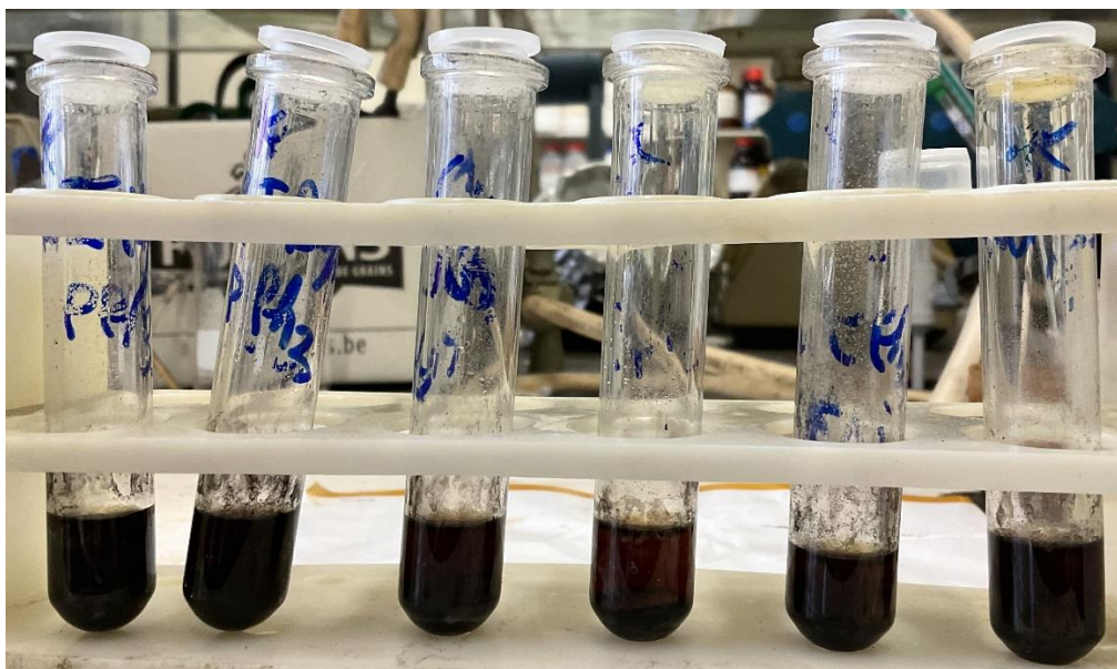
Figure S26 : Solutions de la N-alkylation d'amine avec un alcool primaire et t-BuOK comme base + PPh 3 après chauffage. De gauche à droite, on a les catalyseurs : 1 – 2 – 3 – 4 – 5 – 6.
