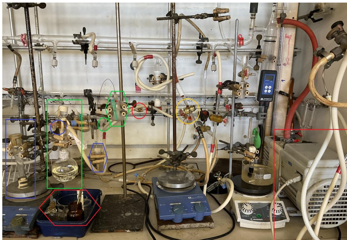
Figure S1 : Dispositif permettant le conditionnement sous atmosphère inerte (N 2 ) du laboratoire.
