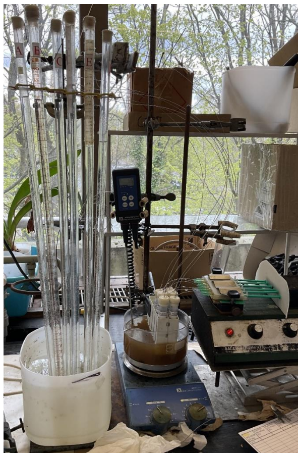
Figure S18 : Fixation des seringues aux tubes d'analyse pour tout injecter en même temps.
