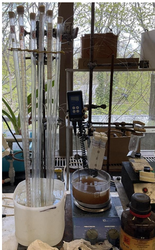
Figure S16 : Setup des colonnes liés par les capillaires aux tubes d'analyse pour la réaction.
