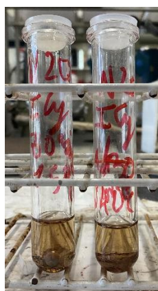
Figure S7 : Solutions avec le catalyseur [Ru(S_2CNEt_2)(S_2C-ICy)_2]Cl ( 3 ) à différentes températures de chauffage après 30 min – De gauche à droite : 150 °C – 140 °C.
