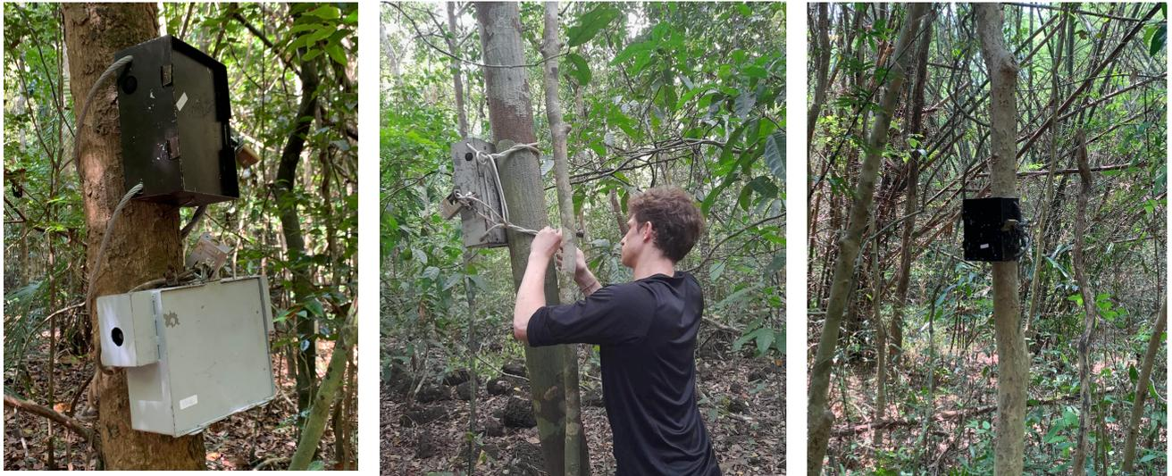
Figure 7 : Photographie d'un SM4 et d'un SM2 déployés sur le terrain dans le PNCT et protégé par un caisse de métal
