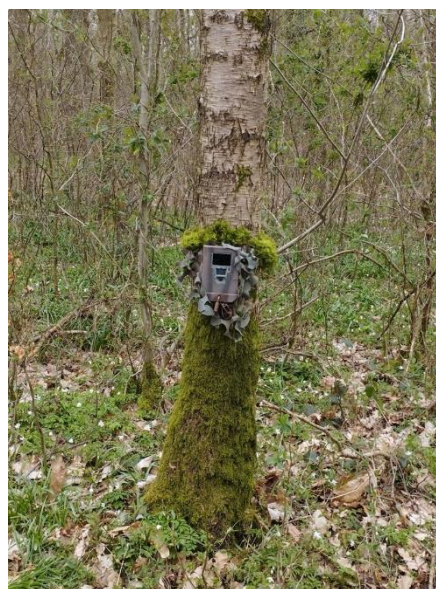
Figures A1 et A2 : Exemples de pièges photographiques installés sur le terrain, dans le boîtier métallique de protection, munis d'une chaîne et d'un cadenas et camouflés. A gauche, le point STAM07, avec un modèle MG984. A droite, le point COLF07, avec un modèle SG2060.
