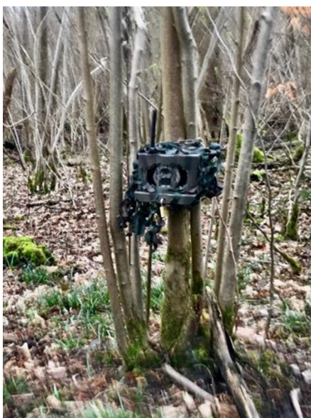
Figures A1 et A2 : Exemples de pièges photographiques installés sur le terrain, dans le boîtier métallique de protection, munis d'une chaîne et d'un cadenas et camouflés. A gauche, le point STAM07, avec un modèle MG984. A droite, le point COLF07, avec un modèle SG2060.
