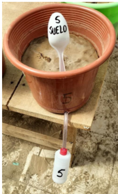
FIGURE 8 – Illustration du pot et du système de collecte des lixivats
