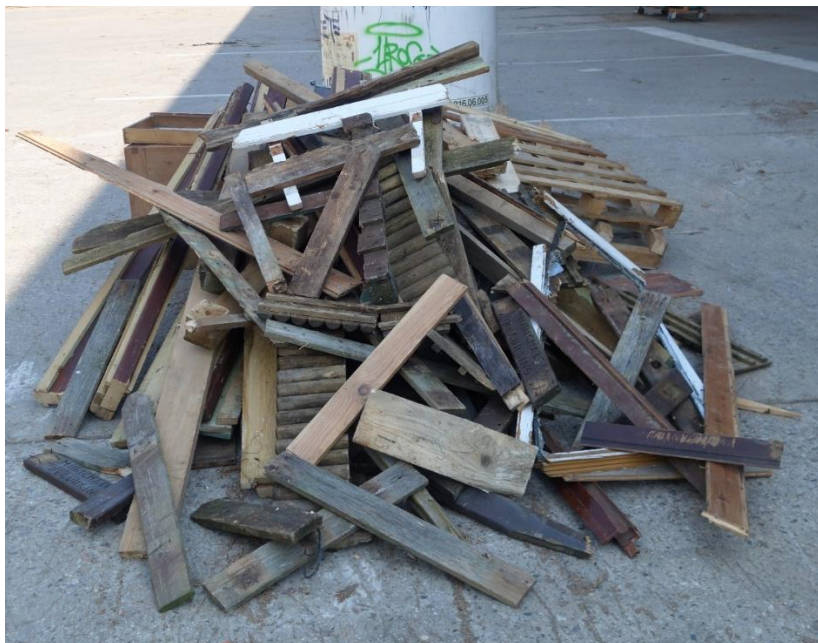
Figure 8 : Photographie du bois trié venant du conteneur de Hastière. Représentation de la catégorie de bois massif respectant les dimensions requises et possédant des corps étrangers (catégorie 4).
