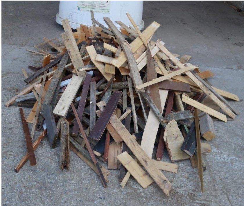
Figure 7 : Photographie du bois trié venant du conteneur d'Hastière. Représentation de la catégorie de bois massif ayant des dimensions inférieures à 50 x 8 x 2 cm et ne possédant pas de corps étrangers (catégorie 3).
