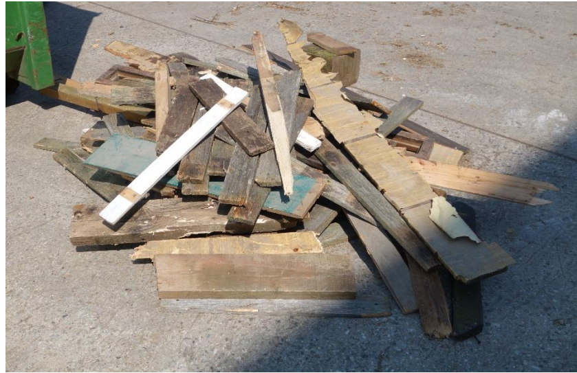
Figure 9 : Photographie du bois trié venant du conteneur de Hastière. Représentation de la catégorie de bois massif respectant les dimensions requises et ne possédant pas de corps étrangers (catégorie 5).
