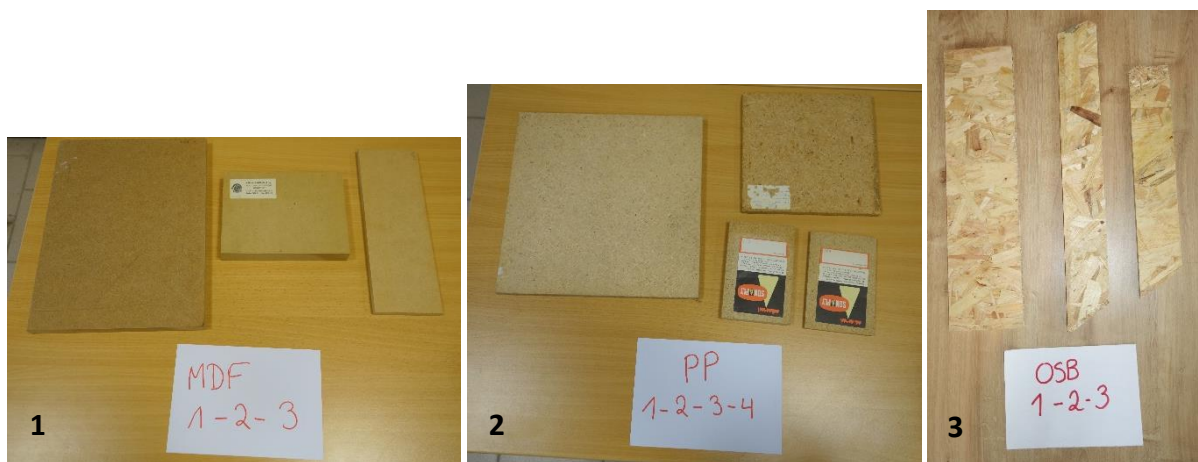
Ensemble des échantillons de panneaux particules : (1) MDF, (2) Panneaux particules, (3) OSB
