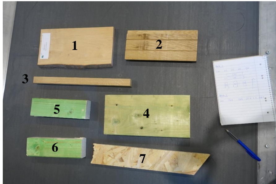
Figure 13 : Prise de note de la disposition du deuxième groupe d'échantillons composés : (1) Hêtre 1, (2) Chêne 4, (3) Chêne 3, (4) Épicéa traité 3, (5) Épicéa traité 1, (6) Épicéa traité 2 et (7) OSB 3.
