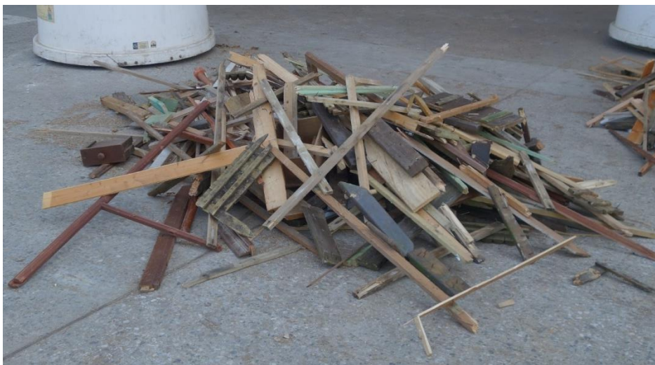
Figure 6 : Photographie du bois trié venant du conteneur d'Hastière. Représentation de la catégorie du bois massif ayant des dimensions inférieures à 50 x 8 x 2 cm et possédant des corps étrangers (catégorie 2).
