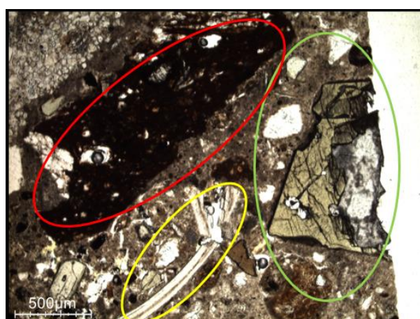
Fig. 106. SL5853_PLV.02. LPNA pyroxène (vert), tuileau (rouge) et fossile (vert).
