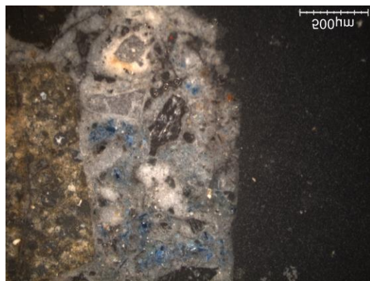
Fig. 125. SL5034_PLV.01. LR Couche 3 présence d'un pigment minéral bleu. Bleu égyptien ?
