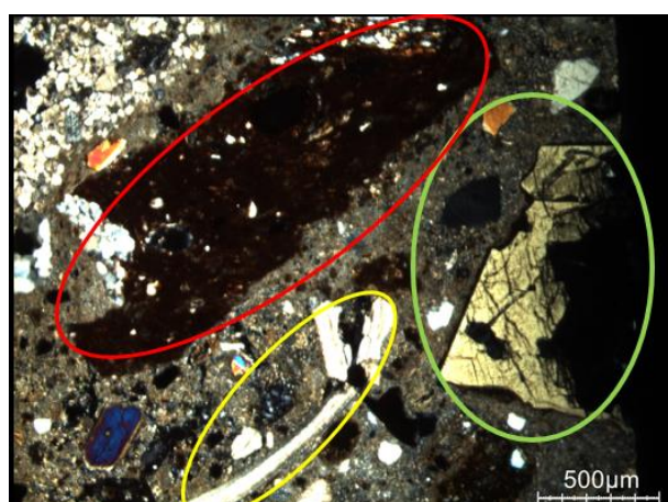
Fig. 107. SL5853_PLV.02. LPA pyroxène (vert), tuileau (rouge) et fossile (vert).
