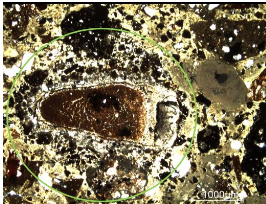
Fig. 93. SL5853_PLV.01. LPNA Couche 3 fragment de roche pyroclastique (vert).
