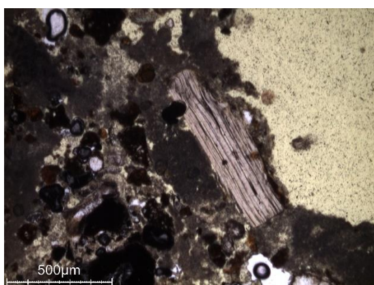
Fig. 146. SL7059_PLV.01. LPNA Couche 3 biotite (mica).
