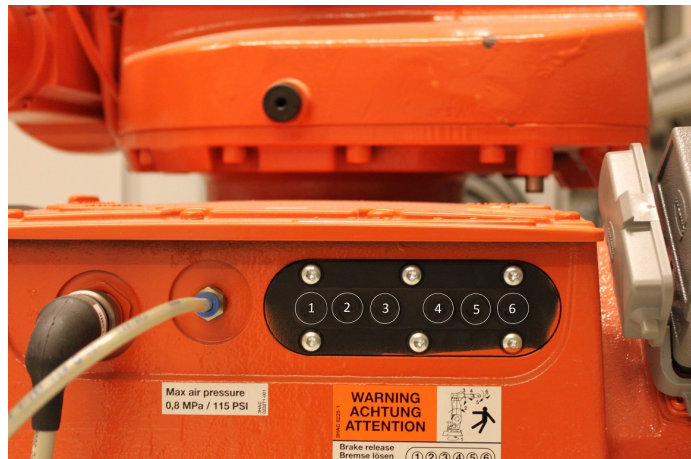
FIGURE 2.6 – Boutons pour relâcher les freins à NE JAMAIS ACTIONNER.
