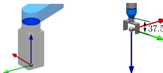
FIGURE 7.6 – Référentiel de l'atelier et de l'outil pour le robot de l'exercice 7.1.
