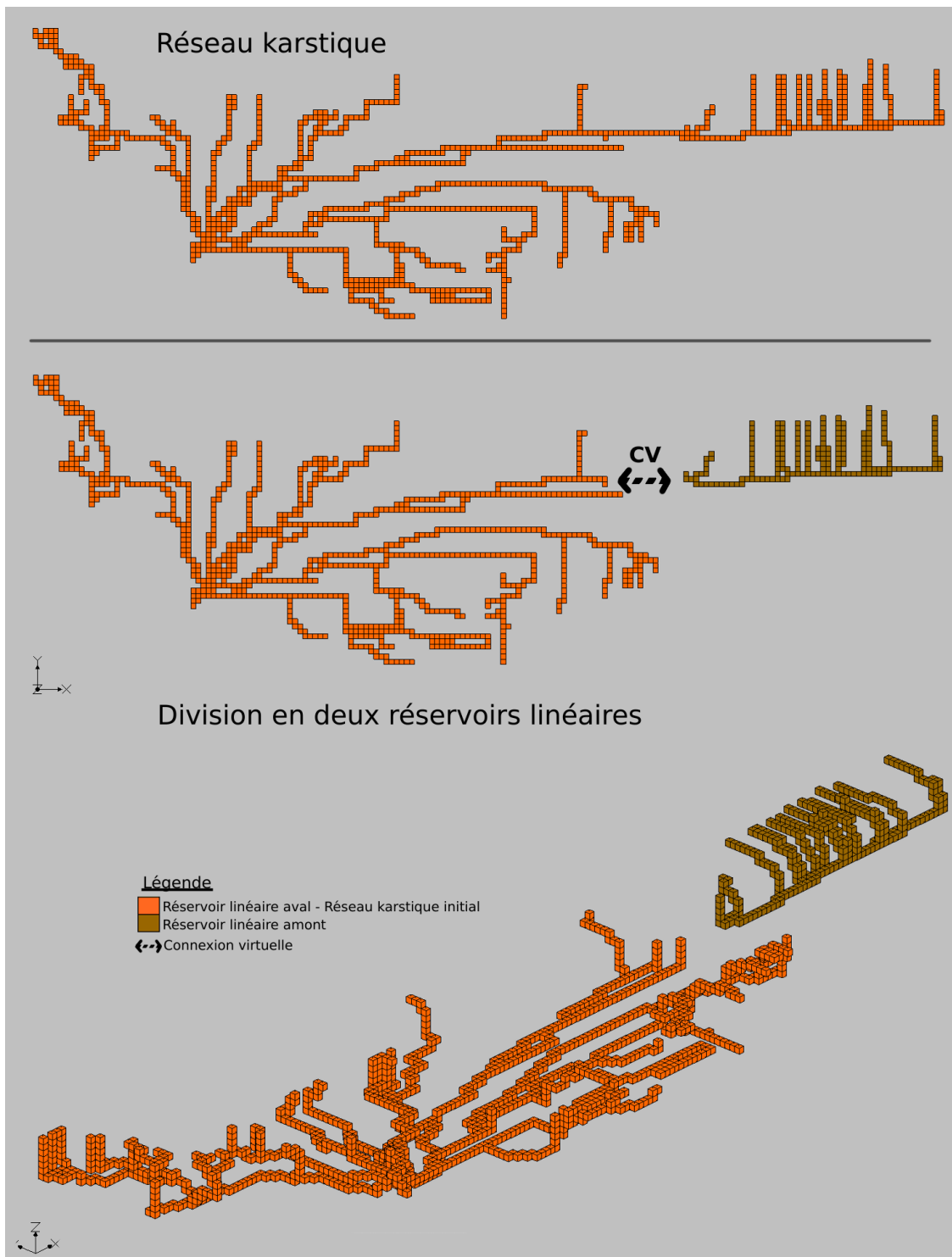
FIGURE 5.10 – Représentation du réseau karstique et des deux réservoirs linéaires utilisés dans la modèle HFEMC.
