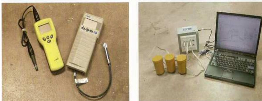
Figure 9: sondes hygrométriques (Howard M.K., 2005)
