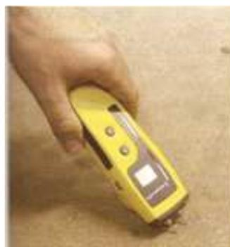
Figure 12: mesure par résistivité électrique (Howard M.K., 2005)
