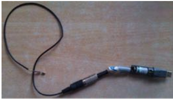
FIGURE B.6 – Sonde hygrométrique et de température
