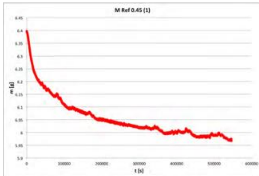
FIGURE 6.40 – Courbe d'évolution de la masse lors d'un séchage convectif
