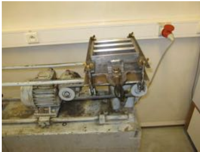
FIGURE 4.4 – Moule fixé sur la table à chocs
