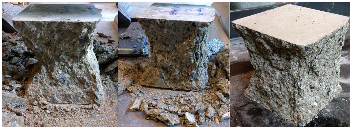
Figure 90 - Rupture à la compression du béton de GN, du béton de GR non traités et du béton de GR traités
