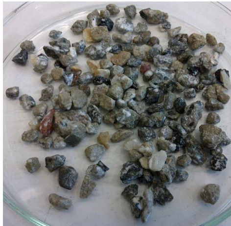
Figure 52 - Retrait de l'enrobage d'amidon par l'eau
