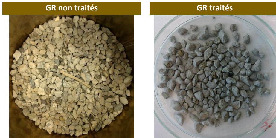
Figure 34 - Modification de la surface après enrobage de ciment
