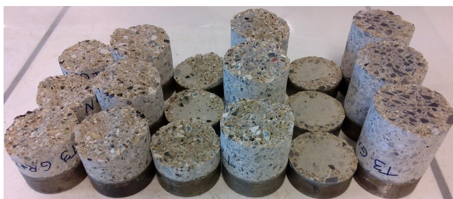
Figure 87 - Surfaces de rupture à la traction du béton de GR traités, du béton de GR non traités et du béton de GN
