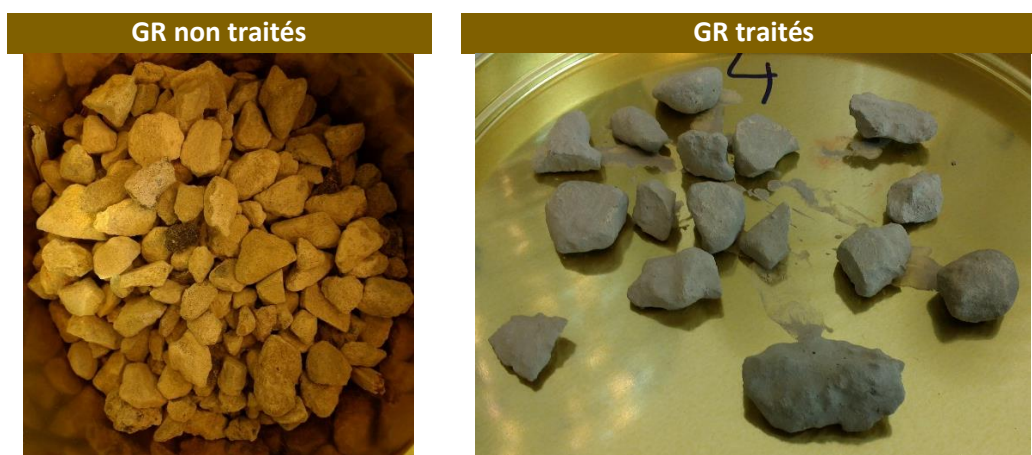
Figure 36 - Modification de la surface après enrobage de ciment et de cendres volantes
