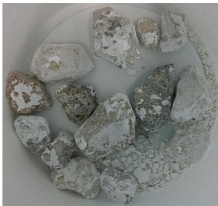
Figure 45 - Problème de décollement de l'enrobage d'amidon
