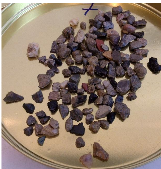
Figure 42 - Aspect luisant des GR traités à l'hydrofuge C
