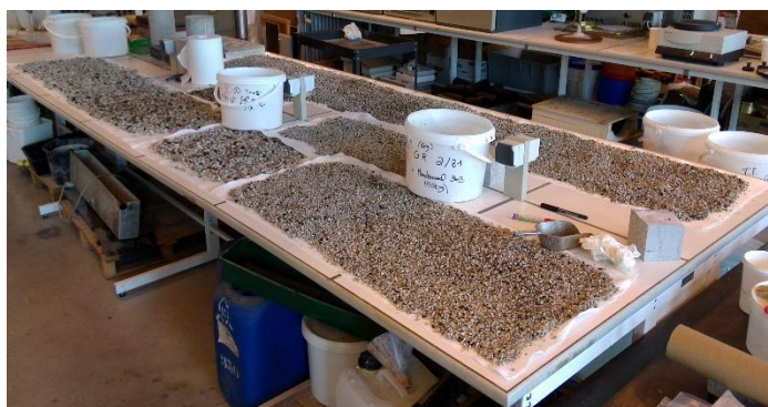
Figure 75 - Séchage à l'air ambiant
