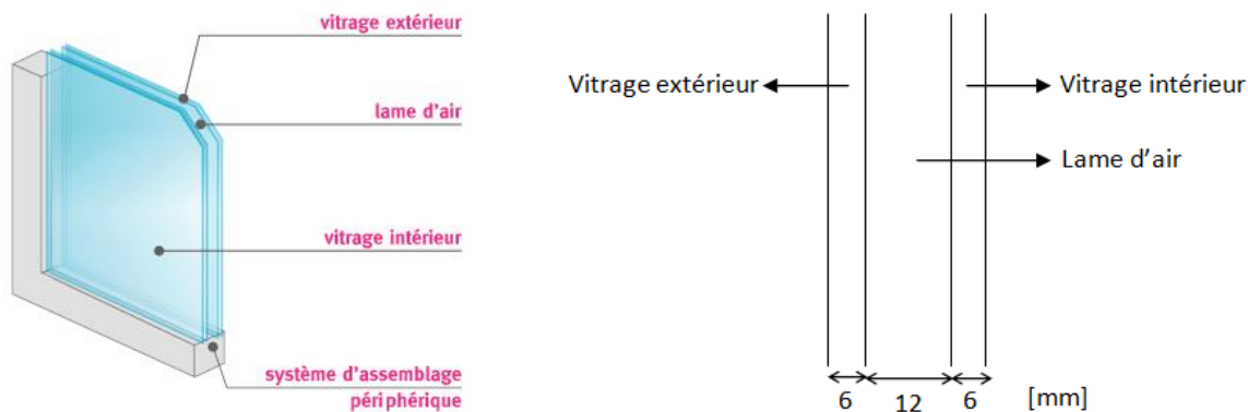
Figure 28 : Double vitrage des fenêtres du bâtiment
