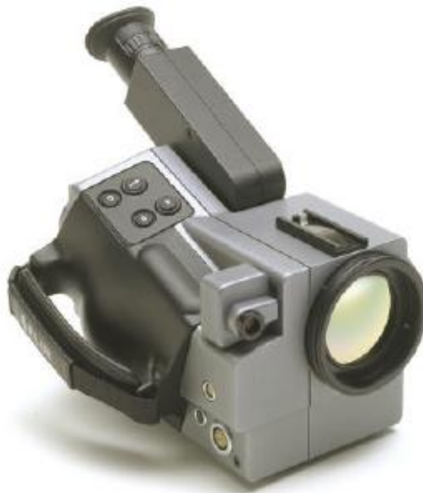
Figure 54 : Caméra Flir ThermaCAM PM 695 utilisée pour la thermographie
