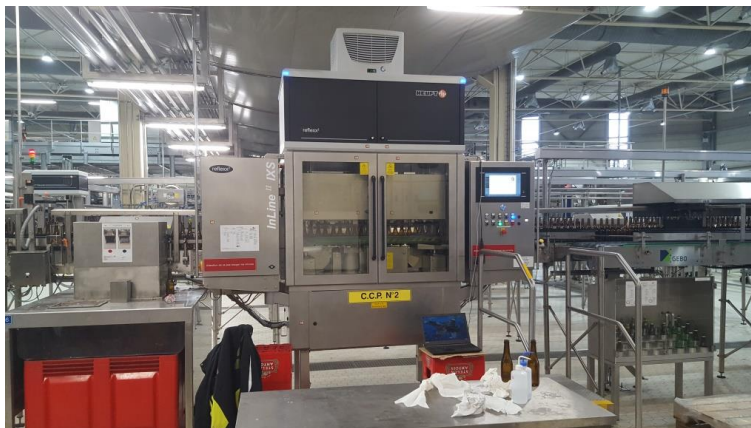
FIGURE 2.4 – Inspectrice EBI - Vérification de la conformité des nouvelles bouteilles.
