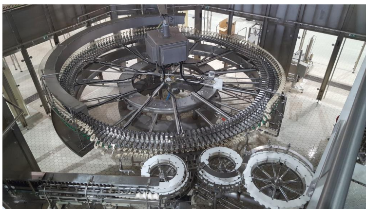
FIGURE 2.5 – Rinceuse - Rinçage des bouteilles pour enlever les poussières.
