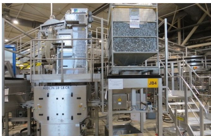
FIGURE 2.9 – Alimentation en capsules -Envoi des capsules et des bouchons dans la capsuleuse.
