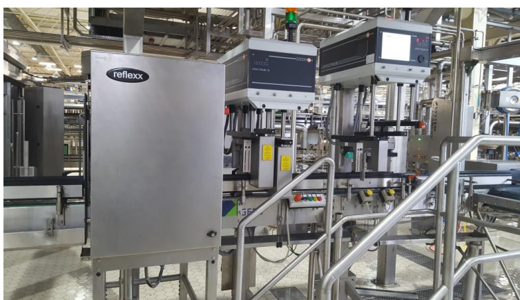
FIGURE 2.10 – Inspectrice FBI - Vérification de la conformité de la bouteille remplie.
