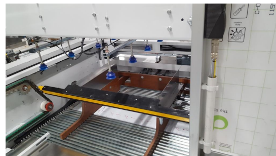
FIGURE 2.15 – Palettiseur - Insertion des différents packs de manière optimale sur une palette.
