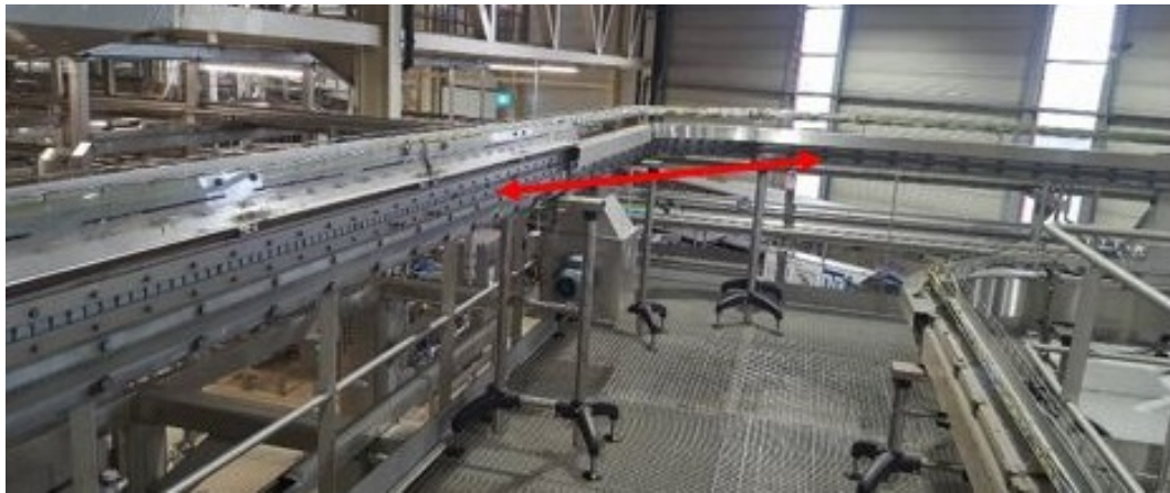
FIGURE 4.19 – Echange de deux barres sur l'alimentation en capsules.
