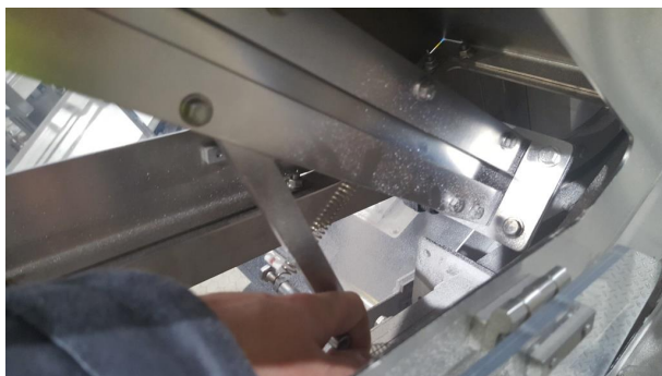
FIGURE 4.21 – Système d'éjection manuelle des capsules installé sur JB5.
