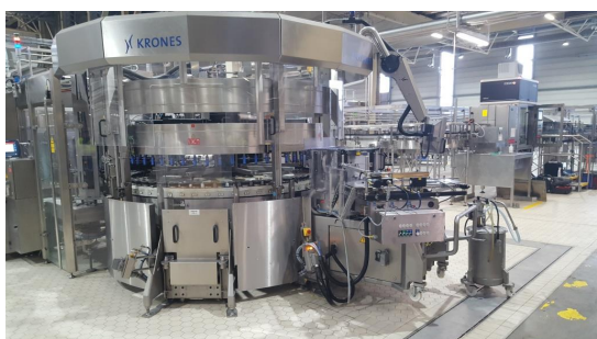
FIGURE 2.12 – Etiqueteuse - Place les étiquettes sur le col, le corps et le dos de la bouteille.
