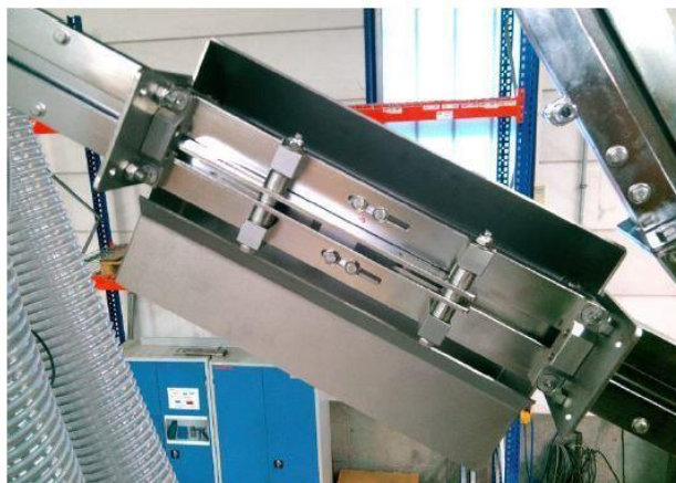
FIGURE 2.28 – Système d'éjection des capsules retournées dans le convoyeur à capsules - [6].
