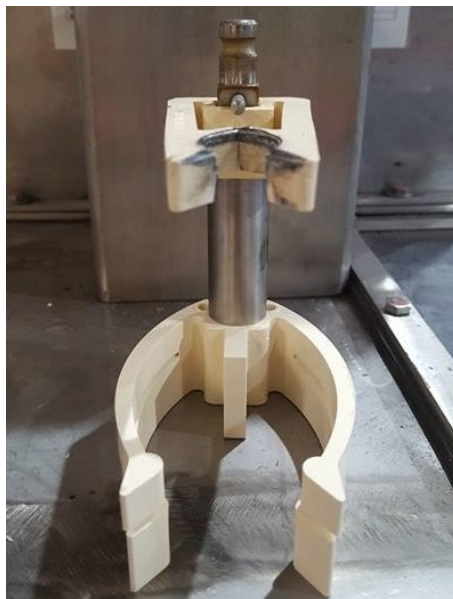
FIGURE 2.20 – Rinceuse - Support de bouteille.
