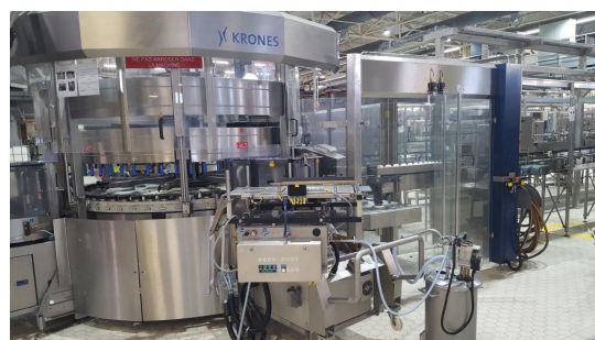
FIGURE 2.12 – Etiqueteuse - Place les étiquettes sur le col, le corps et le dos de la bouteille.
