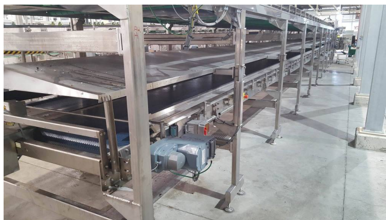
FIGURE 2.13 – Zone tampon - Régulation de la ligne.
