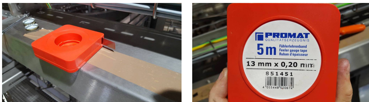
FIGURE 4.18 – Papier métallique de 0.2 mm utilisé pour augmenter l'épaisseur de la glissière.
