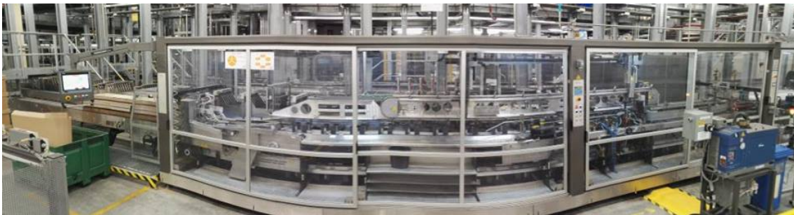
FIGURE 2.14 – Quikflex - Emballage des bouteilles sous différents formats de pack.
