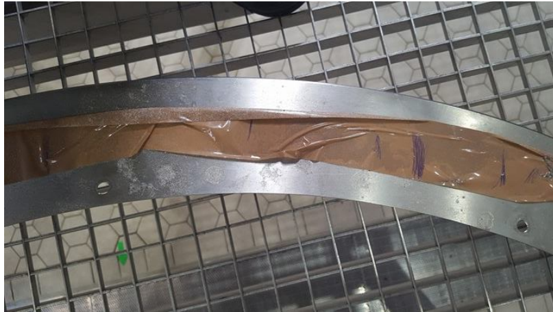
FIGURE 4.11 – Utilisation d’une bande adhésive en vue de déterminer la cause du blocage des capsules dans le convoyeur.
