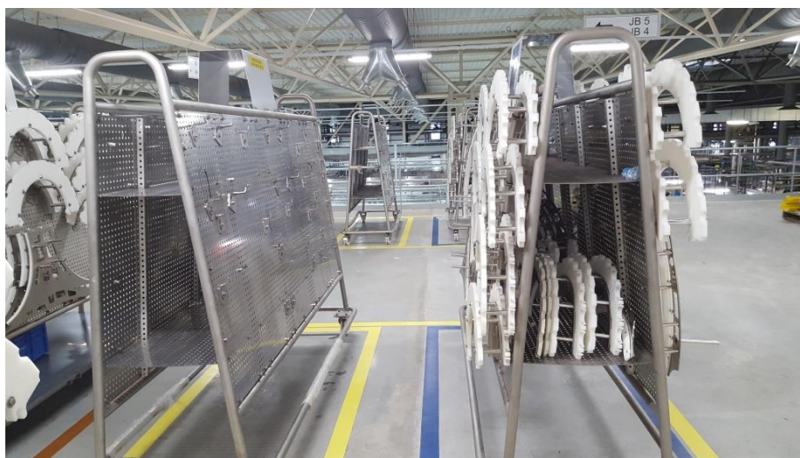
FIGURE 6.5 – Racks de changement de format contenant les guides, les étoiles et les pinces nécessaires au changement de format de la zone soutireuse.
