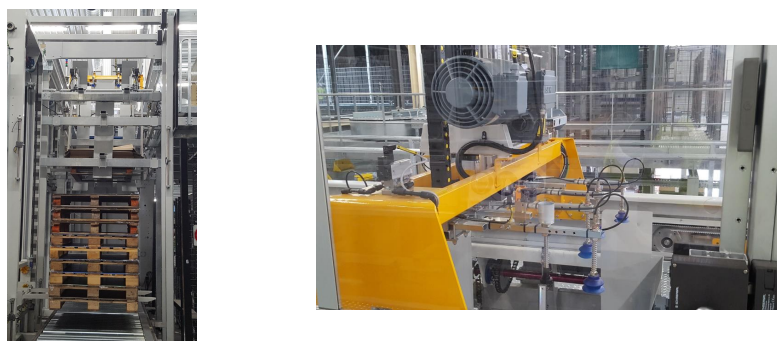
FIGURE 2.2 – Dépalettiseur - Retire les récipients des palettes et les envoie vers le convoyeur.
