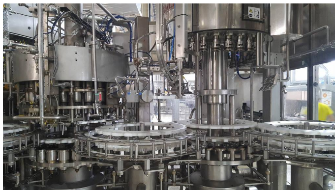
FIGURE 2.8 – Capsuleuse/Boucheuse - Sertissage des bouteilles avec des capsules ou des bouchons.
