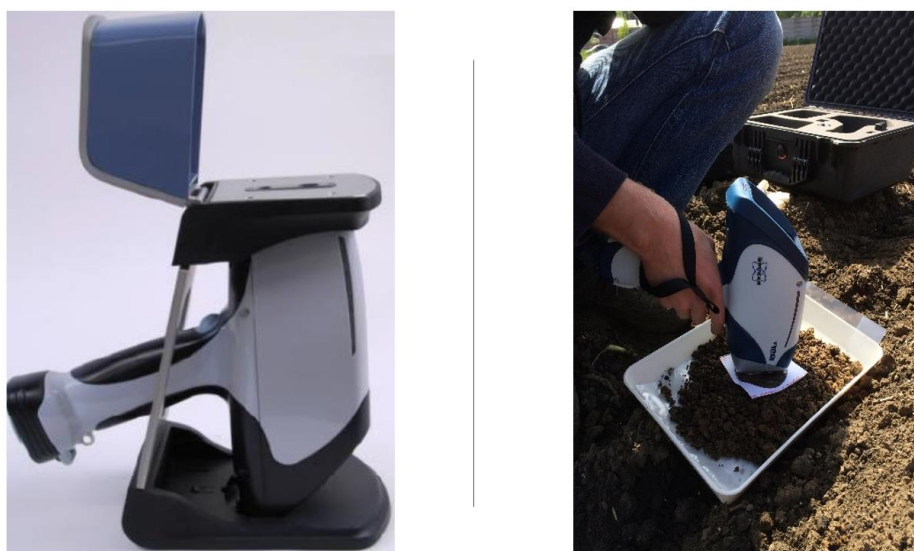
Figure 9 Illustrations des configurations d'utilisation de l'XRF. Photo de gauche: Configuration de laboratoire. Photo de droite: Configuration sur terrain
