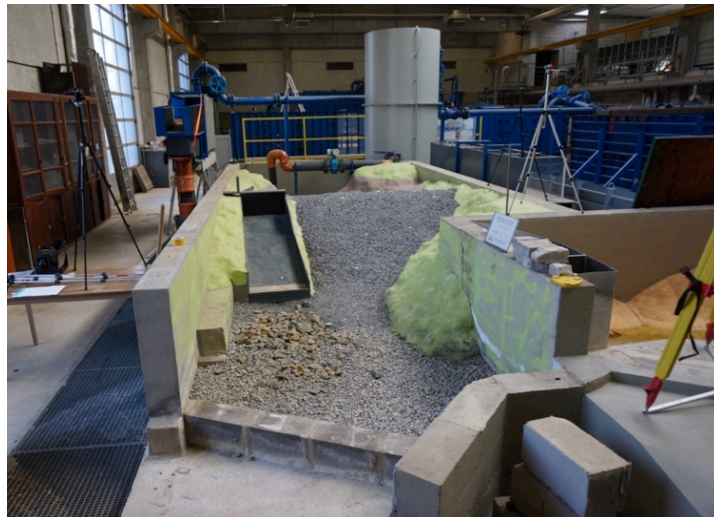
Figure 40 - Maquette de la retenue d'eau.
