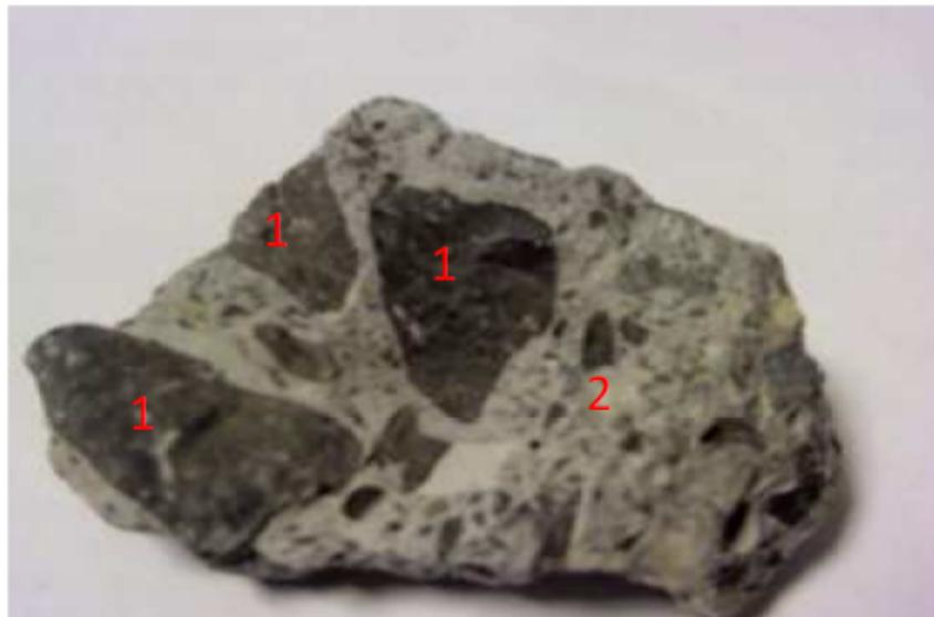
FIGURE 2.10 – Constitution d'un granulat recyclé de béton [59]
