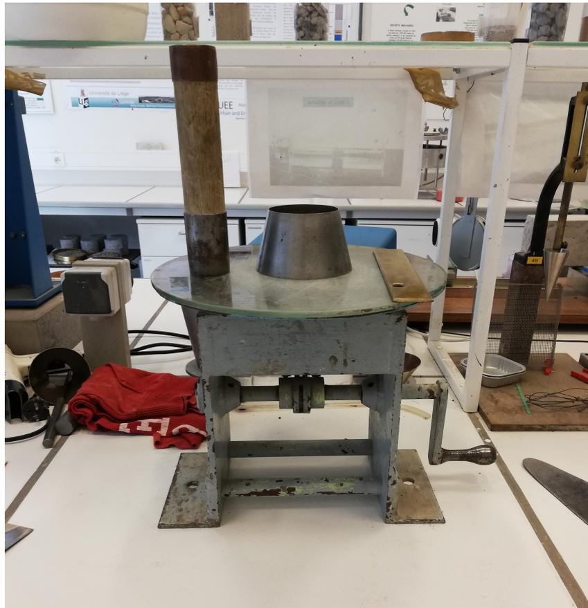
FIGURE 3.9 – Table à secousses, moule conique et dame
