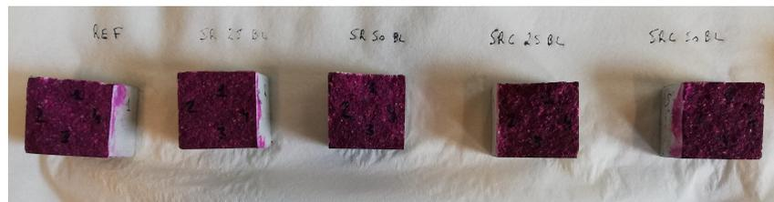
FIGURE 3.17 – Essai de carbonatation
