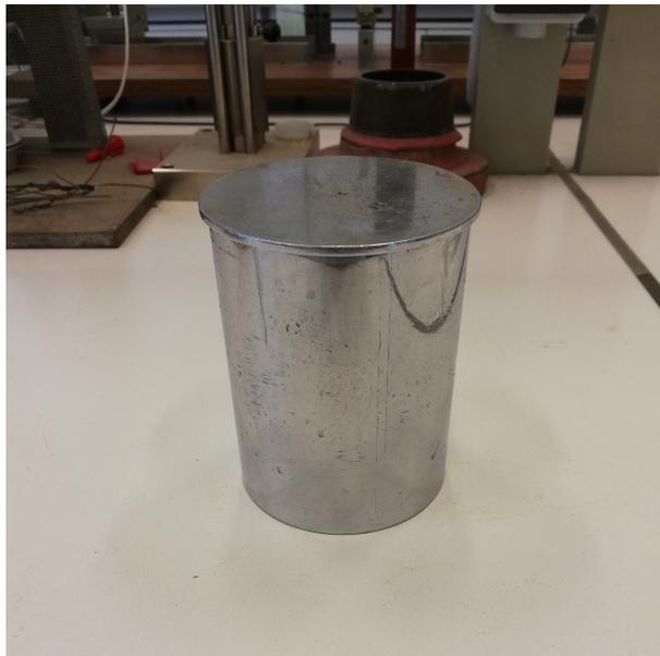
FIGURE 3.2 – Pycnomètre
