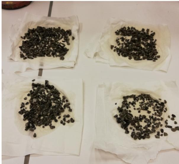
FIGURE 3.3 – Séchage des granulats sur du papier absorbant
