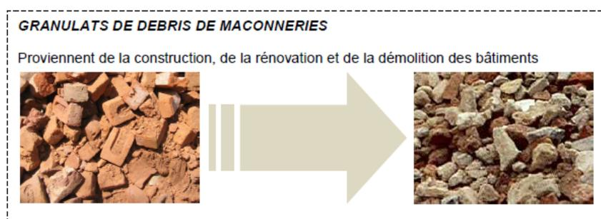
FIGURE 2.7 – Granulats recyclés de maçonnerie [23]
