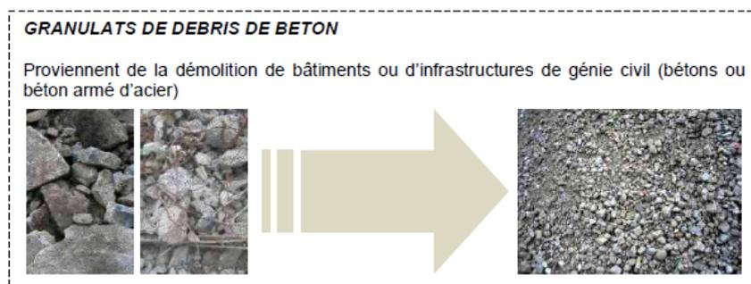
FIGURE 2.6 – Granulats recyclés de béton [23]
