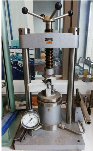
FIGURE 3.16 – Fendage des éprouvettes
