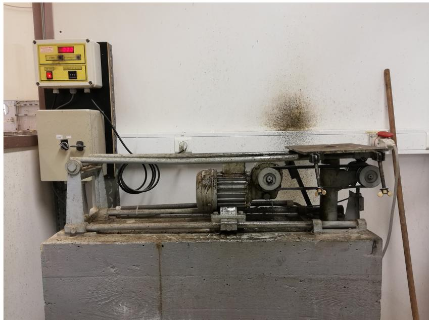
FIGURE 3.8 – Appareil à chocs
