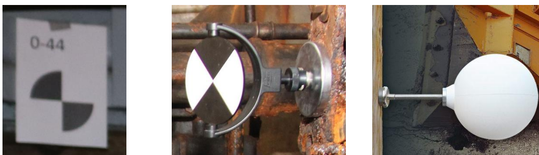
Figure 24 Eléments de repère adaptés à la numérisation laser. Photos personnelles.
