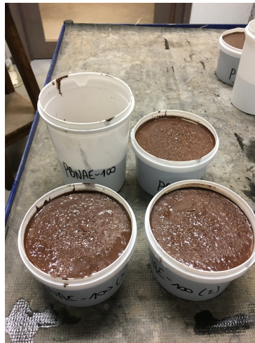
FIGURE 8.7 – Moulage des échantillons destinés aux essais de diffusion des ions chlore
