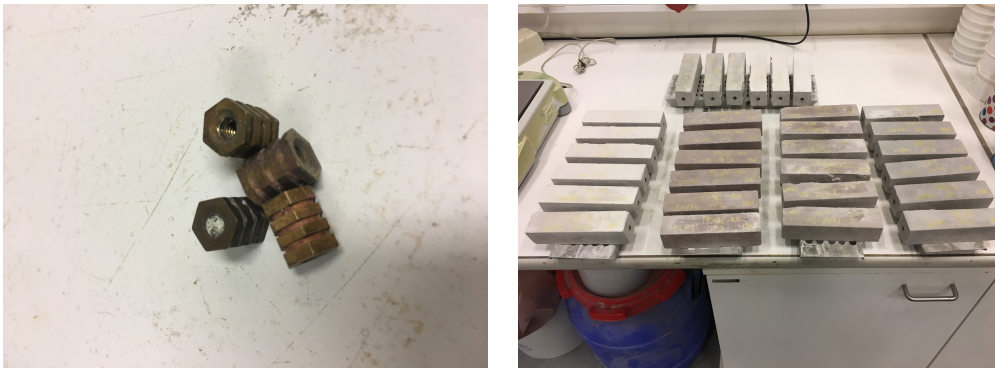
FIGURE 8.15 – Échantillons réalisés pour les essais d'attaque sulfate
