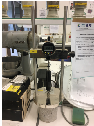
FIGURE 8.16 – Rétractomètre mesurant la variation de longueurs des barrettes de mortier en microns
