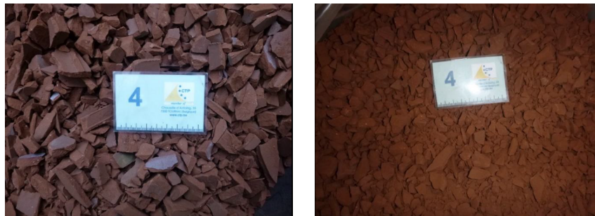
FIGURE 6.5 – Matériaux obtenus après le passage dans les concasseurs à mâchoires D220 et D120 [50]
