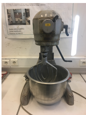
FIGURE 7.2 – Malaxeur utilisé pour réaliser les mortiers (Capacité Max : 5 kg)
