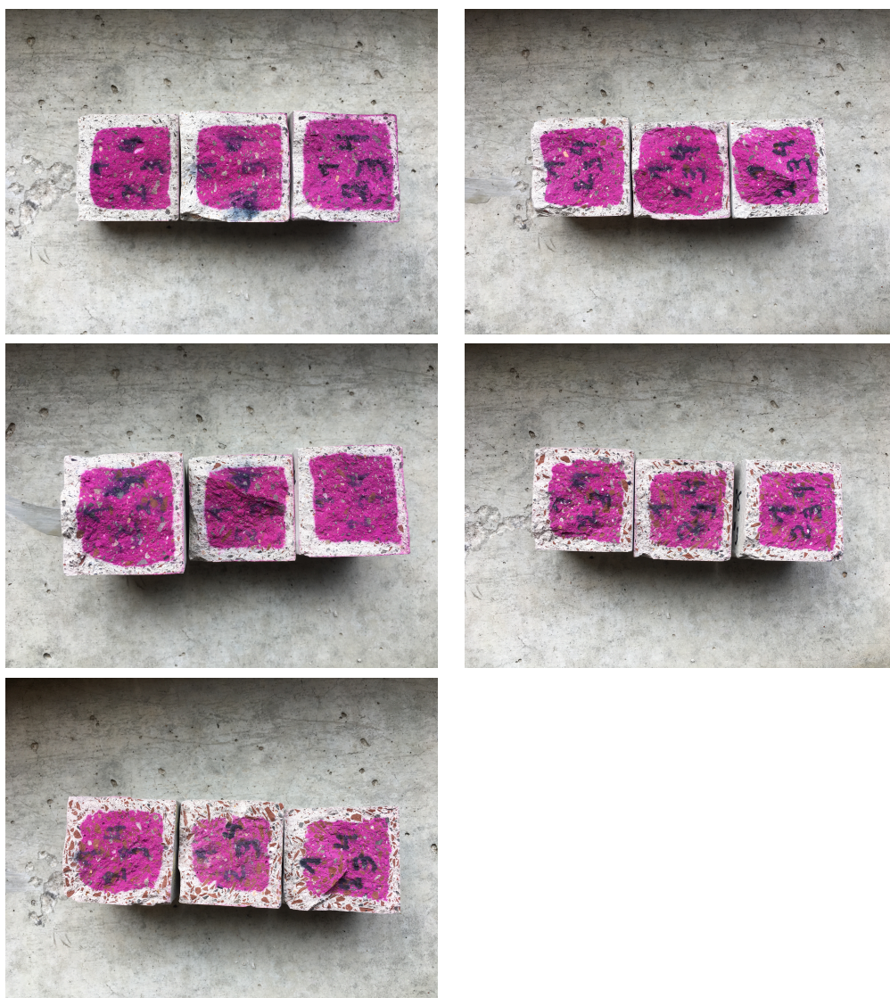
FIGURE H.1 – Carbonatation après 56 jours (Sable de brique). Mélange correspondant de gauche à droite et de haut en bas : SB-0, SB-5, SB-10, SB-25, SB-50
