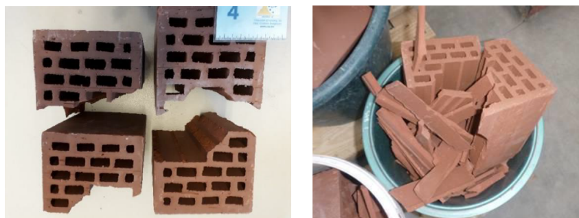
FIGURE 6.3 – Briques recyclées et cassées en morceaux de tailles inférieures à 200mm [50]
