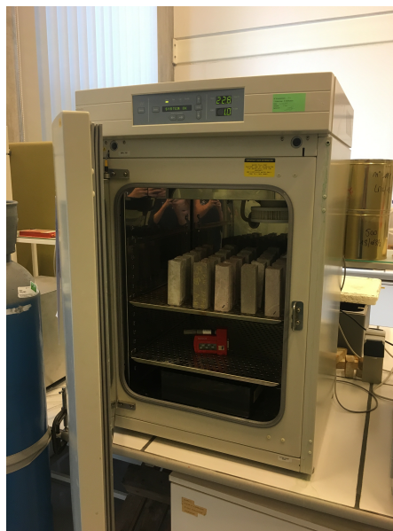
FIGURE 8.4 – Caisson de stockage des éprouvettes pour l'essai de carbonatation (Concentration CO_2 = 1 %, Température = 23^\circ C \pm 1^\circ C , Humidité = 65 \% \pm 5 \% )
