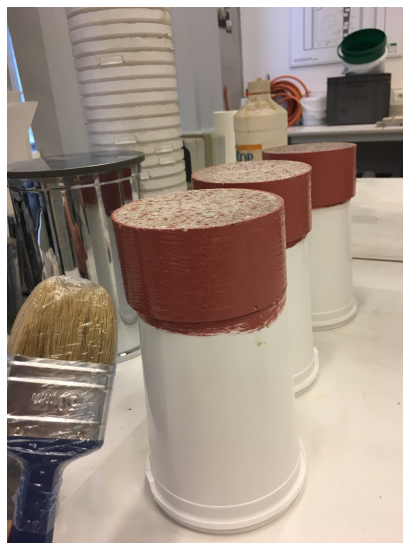
FIGURE 8.11 – Échantillon cylindrique pour le test de diffusion d'ions chlore forcée recouvert d'une résine époxy
