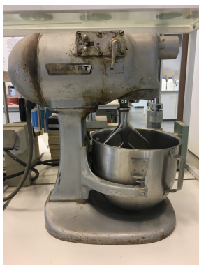
FIGURE 7.1 – Malaxeur utilisé pour réaliser les mortiers (Capacité Max : 2.5 kg)
