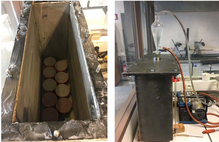
FIGURE 8.12 – Saturation en eau des échantillons destinés à l'essai de diffusion d'ions chlore forcée
