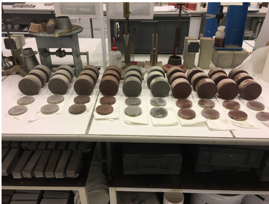
FIGURE 8.9 – Échantillons réalisés pour les essais de diffusion d'ions chlore (Diffusion en régime stationnaire et Diffusion forcée)
