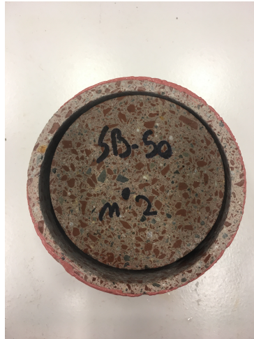
FIGURE 8.17 – Échantillons récupérés et modifiés pour réaliser l'essai d'absorption d'eau par immersion
