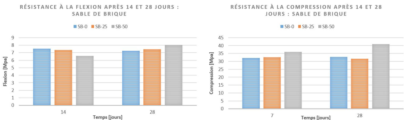
FIGURE 2.14 – Résistance à la flexion (gauche) et à la compression (droite) de mortiers auto-compactants avec substitution de sable de brique [50]
