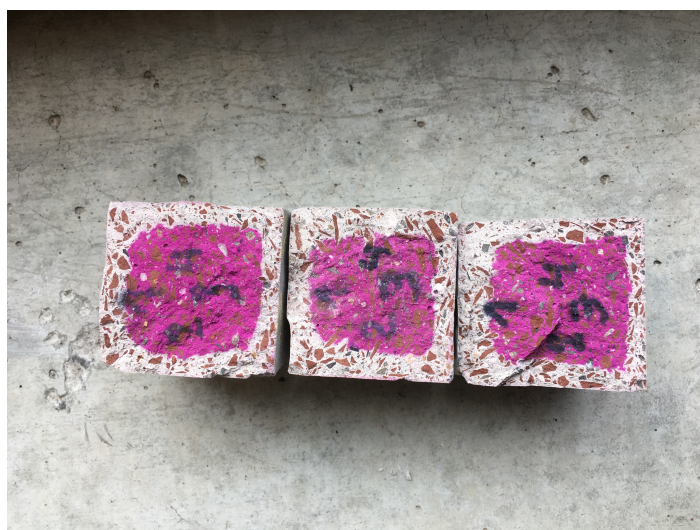
FIGURE 2 – Carbonatation d'échantillons composés de sable de brique
