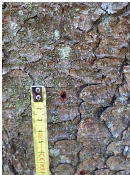
FIGURE 14 – Blessure causée par la mise en place du Fakopp TreeSonic timer
