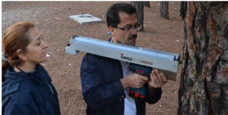
FIGURE 8 – Photo d'un résistographe. Illustration issue de GULLER et al. (2012)
