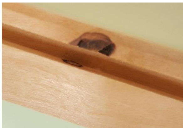
Figure 38 : Nœud présent au niveau d'une rainure.
