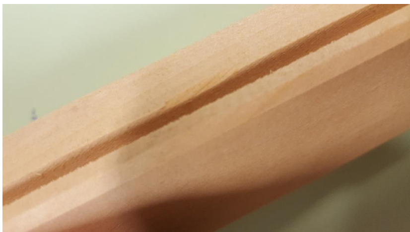
Figure 41 : Contrefil dans rainure de traverse.
