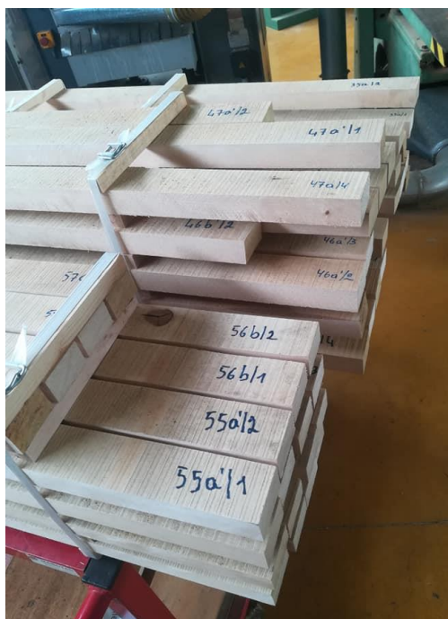
Figure 28 : Echantillons finaux, triés et dimensionnés au LTB, et destinés aux essais d'usinage chez Kewlox.
