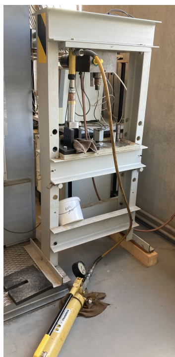
FIGURE 4.2 – Vérin hydraulique et piston
