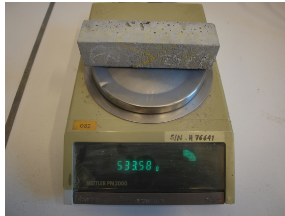
FIG. 70 Pésée à l'air de l'éprouvette sèche
