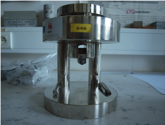
FIG. 63 Dispositif de flexion utilisé
