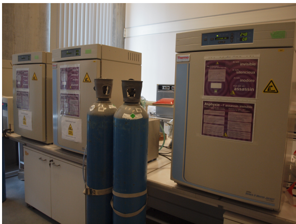
FIG. 49 Dispositif de carbonatation accélérée
