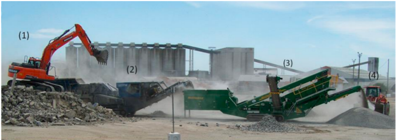
FIG. 5 : Différentes étapes de la production des Granulats Recyclés de Planète Recyclage : (1) Préparation par broyage des blocs de béton armé et déferage à l'aide d'une pince de type BRH, (2) concassage, (3) criblage et (4) stockage (source : Recyment). [6]
