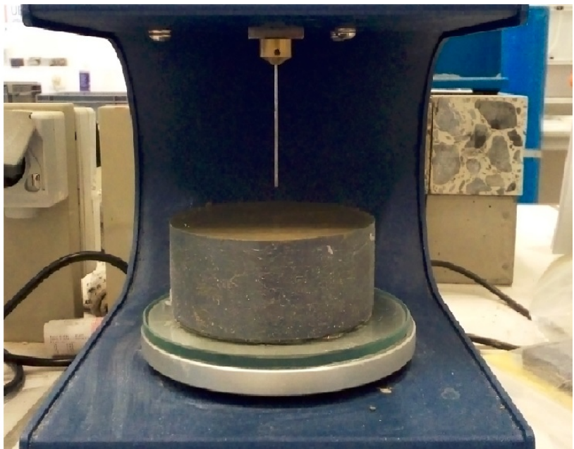
FIG. 57 Appareil de Vicat
