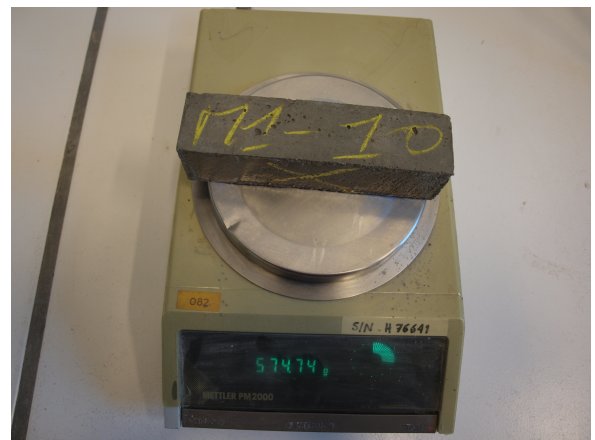
FIG. 67 Pésée à l'air de l'éprouvette humide
